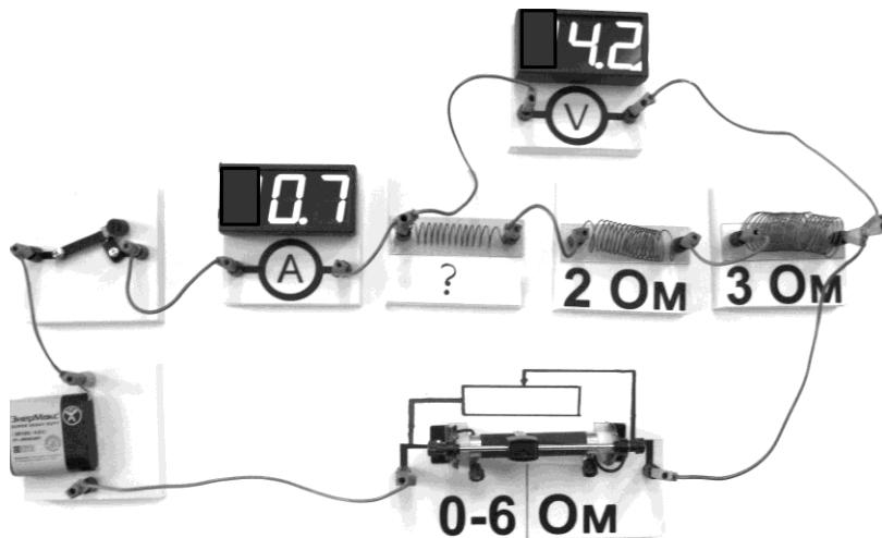
Чему равно сопротивление неизвестного резистора? Вольтметр и амперметр считать идеальными.
